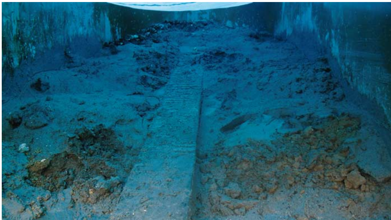
Cinza e chorume (lama) acumulados em recipientes sem proteção, Usina Verde S/A Cenizas y escorias almacenadas en contenedores sin protección, en el predio de Usina Verde S/A
