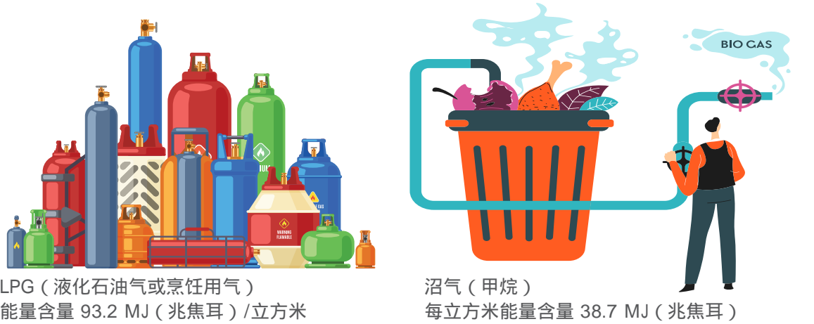
图 3. 液化石油气和沼气（甲烷）的能量含量比较
